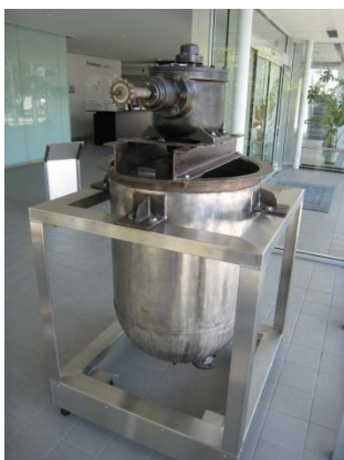
縦型円筒型グリース製造釜 ーダブルアクション攪拌タイプー
