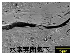
Fig.3 はく離部の断面
