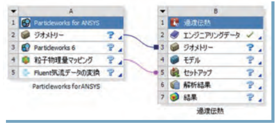
③ Ansys Mechanicalに熱伝達係数を境界条件としてインポート
