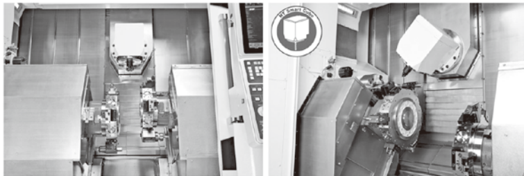
図9 工具主轴とロアタレット
