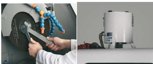
簡単な切断砥石交換作業
