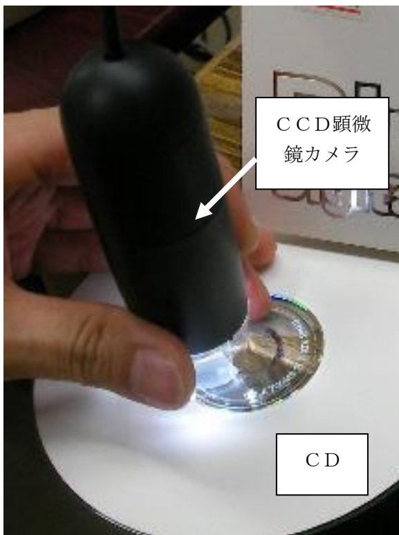
図 1 CCD 顕微鏡カメラで CD の透明部分を通してテープの字にピントを合わせる
