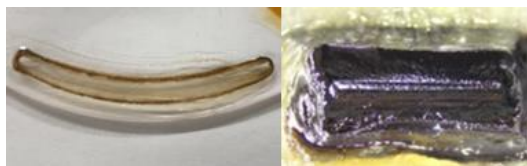
Fig.5 Glass and rubber specimen after testing 析可能であるため、Fig.5 に示す接触二固体面(パッキン側、ガラスディスク側)の Ramman, FT-IR 分析も実施した。Ramman (Fig.6 上段)では MoS 2 を FT-IR (Fig.6 下段)からは
