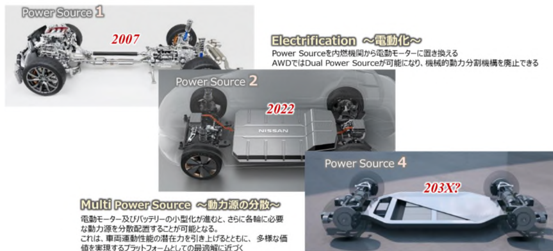
図.8 パワートレイン/車両プラットフォームの進化
