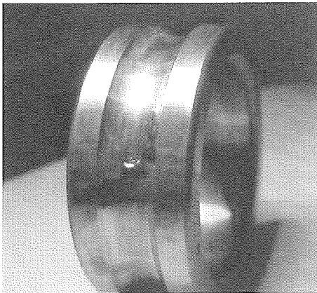
図 1 玉軸受内輪軌道溝のフレーキング
