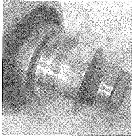
図9 内輪をはめた軸のフレッチング
